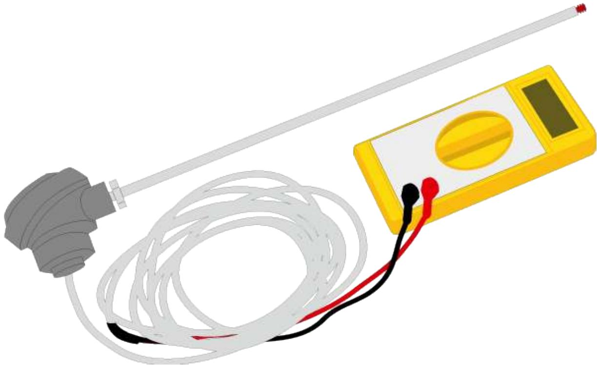
Une sonde à oxygène travaille en comparant le niveau d'oxygène dans le four avec celui dans le senseur. C'est la raison pour laquelle l'air dans le senseur doit être renouvelé constamment. Si la température à la pointe du zirconium dépasse env. 700 °C, une tension électrique se produit. Le moins d'oxygène se trouve dans le four, le plus élevée est la tension électrique, ainsi elle peut servir comme indication du niveau d'oxygène.
